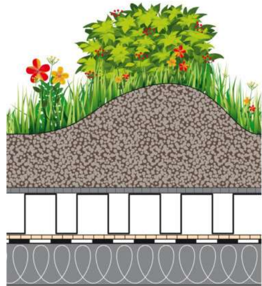
Abb. 18 Schnitt Biodiversitätsgründach (BuGG)
