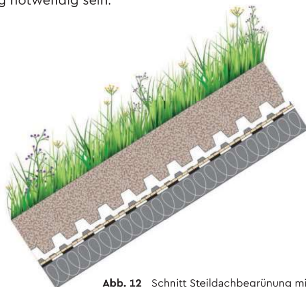
Abb. 12 Schnitt Steildachbegrünung mit Rutschsicherung (BuGG)
