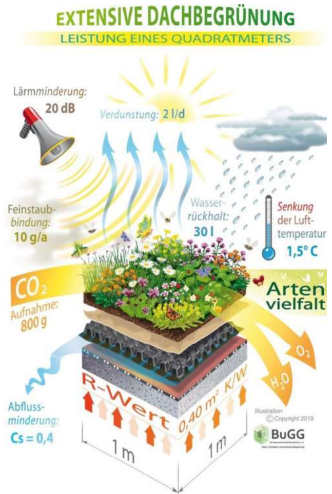
Abb. 1 Extensive Dachbegrünung – Leistung eines Quadratmeters (BuGG)
