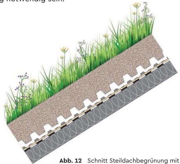
Abb. 12 Schnitt Steildachbegrünung mit Rutschsicherung (BuGG)
